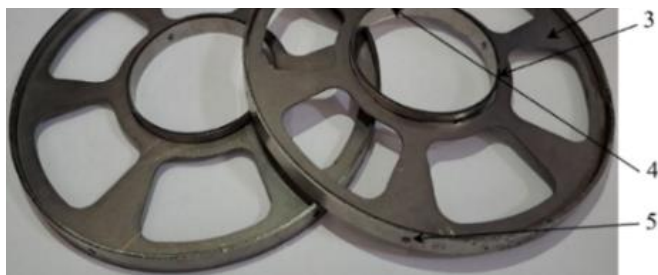
Рис. 1. Новая конструкция междупильной прокладки линтерной машины: 1 – наружный пояс; 2 – диск; 3 – внутренний пояс; 4 – прямоугольные шлицы; 5 – прямоугольные выступы
