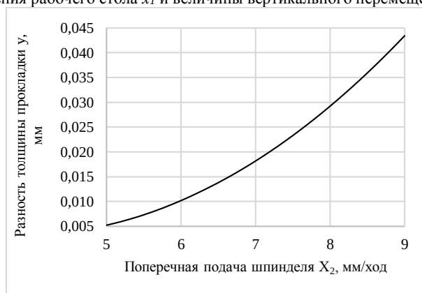
Рис. 6. Изменение разности толщины междупильной прокладки линтерной машины в зависимости от скорости поперечной подачи шпинделя x_2
